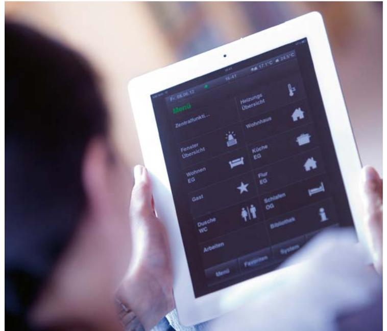
**Der Gira HomeServer ist der Bordcomputer für das intelligente Gebäude. Er verbindet die Elektroinstallation des KNX Systems mit dem Computernetzwerk und dem Internet. Damit ermöglicht er die zentrale Steuerung smarter Gebäudetechnik über eine Vielzahl an Bediengeräten, wie z. B. Smartphone oder Tablet – und das unabhängig vom Aufenthaltsort.**
