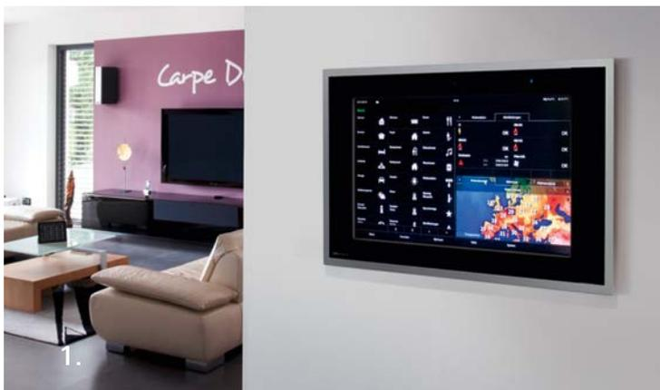
1. Zentrale Bediengeräte, wie der Control 19, ermöglichen die Steuerung von Leuchten, Jalousien und anderen KNX fähigen Geräten, welche über die KNX Installation verbunden sind.
